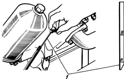
Рисунок 53 – Проверка уровня масла в картере масляного двигателя:
