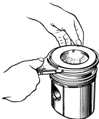
Рисунок 78 – Снятие и надевание поршневых колец на поршень
