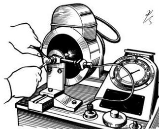
Давление начала впрыскивания форсунки модели 267-01 регулируется винтом при снятом колпаке форсунки и отвернутой контргайке. При ввертывании винта давление повышается, при вывертывании - понижается.
