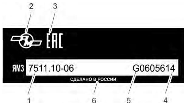
Рисунок 43 – Заводская табличка двигателя ЯМЗ-7511.10-06
