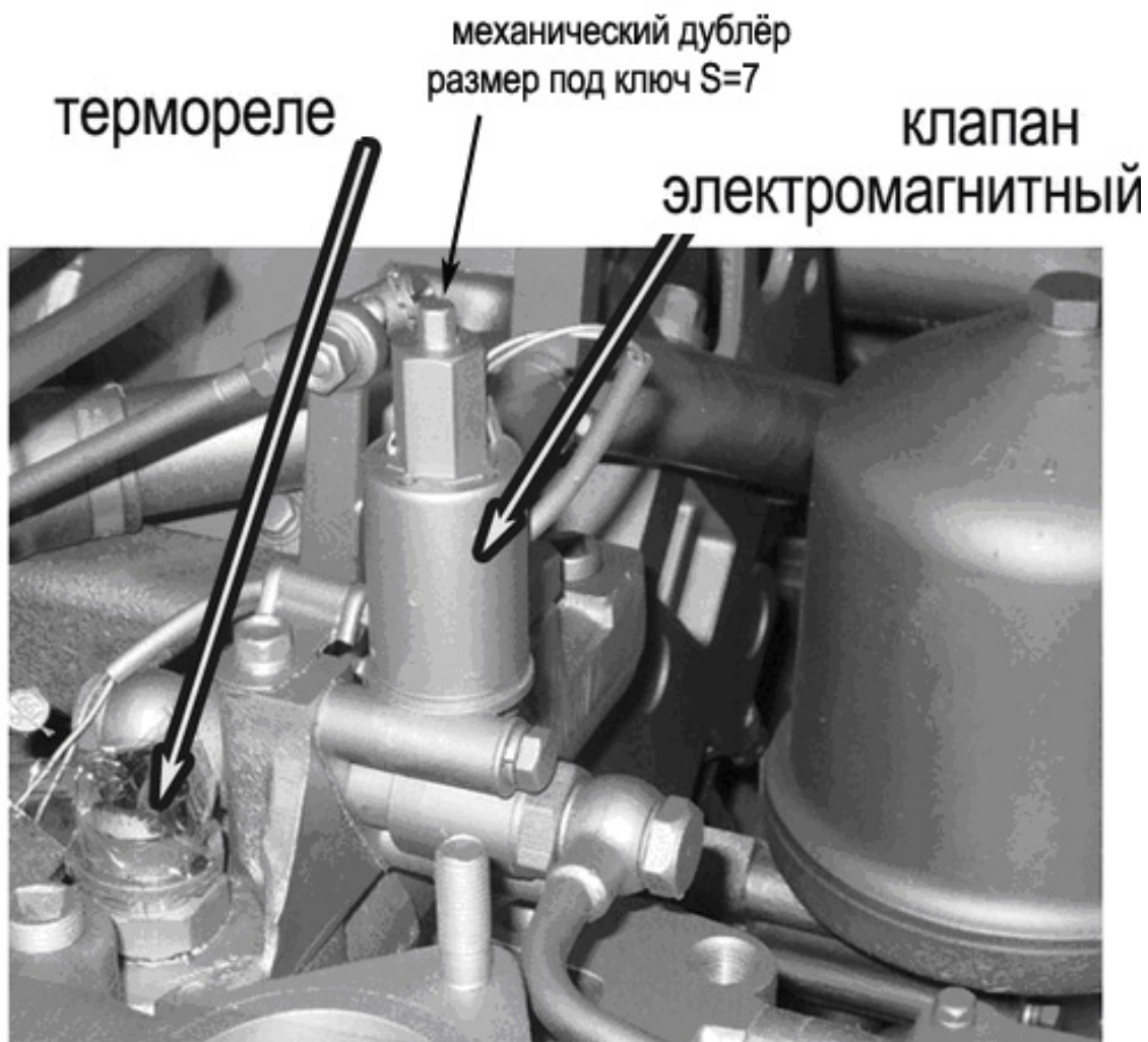
Устройство включения привода вентилятора
