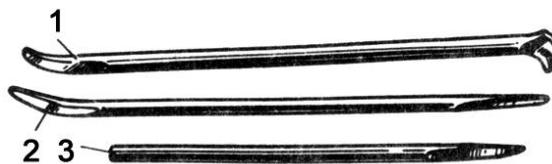
Рисунок 60 - Монтажные лопатки
