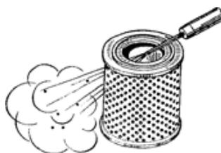
Рисунок 37 - Продувка фильтрующего элемента
