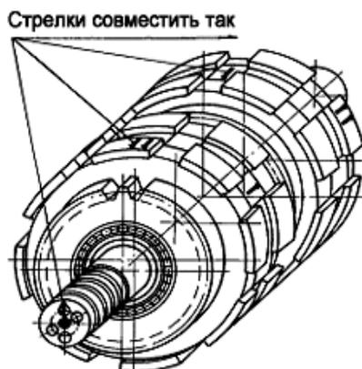
Рисунок 79 - Установка гидроджимных муфт
