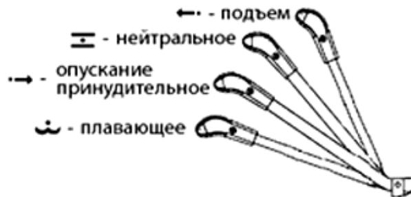
Рисунок 8 - Схема положения рычага управления распределителем
