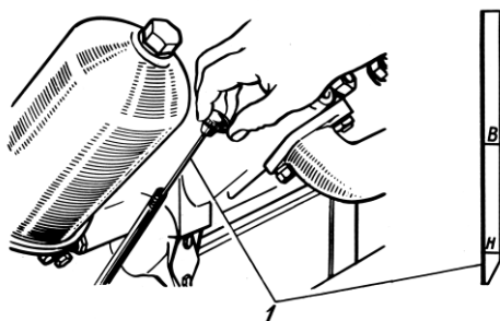
Рис. 66. Проверка уровня масла в картере двигателя: 1 – указатель уровня масла
